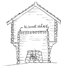
Eksempel på ei kjerne, laftet tørkehus for korn, malt og lin etc.
